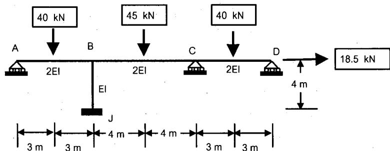
4. ( 30 คะแนน ) จงวิเคราะห์โครงสร้างในรูปข้างล่างนี้แล้วเขียน bending moment diagram ( use moment distribution with successive sway correction )
