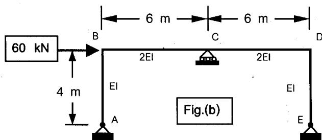
2. (25 คะแนน) คำนวณเนื้อง ABCD รับแรงดังแสดงในรูป ถ้า support C มีการหักดิบขึ้น 0.05 เมตร จงวิเคราะห์แล้วเขียน bending moment diagram ( กำหนดให้  $E = 2 \times 10^8 \text{ kN/m}^2$ ,  $I = 1.200 \times 10^{-5} \text{ m}^4$  )
