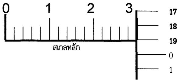
2.2 จากสเกลของไมโครมิเตอร์ดังรูป เมื่อกำหนดให้จาก 0 → 1 ของสเกลหลัก คือ ระยะ 0.1 นิ้ว
