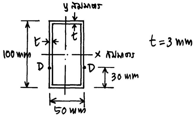
ข้อ 4 (10 คะแนน) คานช่วงเดียวธรรมดา (simply supported beam) เป็นคานผนังบางสม่ำเสมอ 3 mm มีหน้าตัดขวาง 2 แบบดังแสดงในรูป แต่ละแบบรับแรงในแนวตั้ง ( $\downarrow$ ) ผ่าน shear center ของหน้าตัดขวาง ในแต่ละแบบของหน้าตัดขวาง จง
