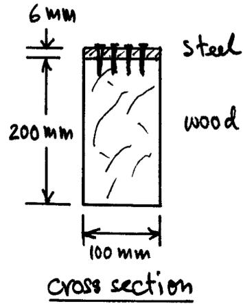
1.2 (5 คะแนน) เมื่อ simple beam ที่ทำด้วย homogeneous material มีความยาวช่วง  $l$  รับ uniformly distributed load  $w$  มีค่า  $EI$  คงตัว ระยะ โกงตัวสูงสุด (maximum vertical deflection) ของคานเท่ากับ  $5wl^4/(384EI)$  เมื่อนำคานที่มี cross section คล้ายกับคานประกอบในข้อ 1.1 โดยแผ่นเหล็กจะยึดติดอยู่ด้านล่างแทนที่จะอยู่ด้านบน และรับ load ดังแสดง จงหา maximum vertical deflection ของคานประกอบนี้
