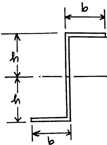
ข้อ 5 (15 คะแนน) แปเหล็กกล้าชนิด light channel มีความหนาสม่ำเสมอ  $t = 3 \text{ mm}$  รับกระเบื้องหลังคาที่เอียงทำมุม  $30^\circ$  กับแนวราบ แปนี้เป็น overhanging beam ดังแสดงในรูป รับแรงแผ่กระจายสม่ำเสมอ  $700 \text{ N/m}$  ในแนวตั้งผ่าน shear center ของหน้าตัดขวาง
