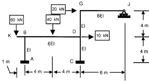
3. (30 คะแนน) จงหาค่า displacements ของ joints ต่าง ๆ ของ a plane truss ในรูปข้างล่างนี้ โดย direct stiffness method และให้แสดง matrices ต่าง ๆ ดังต่อไปนี้ด้วย
