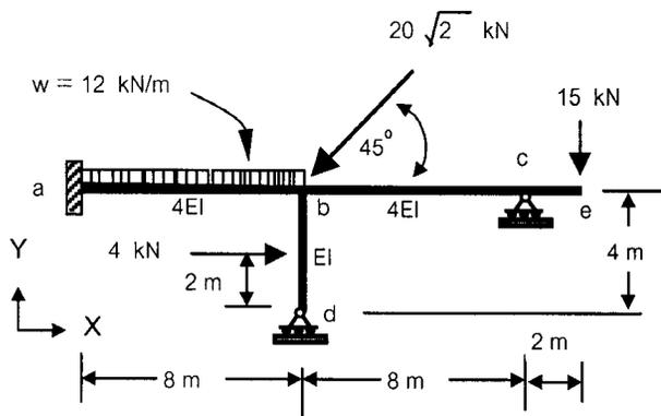
5. (25 คะแนน) โครงสร้างเหล็กในรูปข้างล่างต้องรับแรงกระทำ (working loads) ดังแสดง ถ้ากำหนดให้ใช้ Load factor = 1.80 และให้ใช้ค่า  $\sigma_y = 240 \text{ N/mm}^2$  จงหาค่า  $M_p$  ที่ต้องใช้ในการออกแบบ และจงออกแบบขนาดหน้าตัดชิ้นส่วนของโครงสร้างนี้ (สมมติว่ามีหน้าตัดเป็นรูปสี่เหลี่ยมผืนผ้า)
