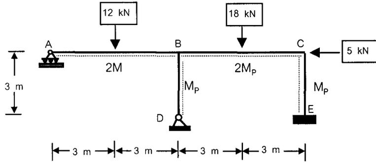
6. (25 คะแนน) จงวิเคราะห์หา end moments และแรงปฏิกิริยาของโครงสร้างในรูปข้างล่างนี้ ทั้งนี้ให้พิจารณา beam-column effects ด้วย แต่ไม่ต้องพิจารณา effects of axial deformation ( $E = 2 \times 10^8 \text{ kN/m}^2$ ,  $I = 3.32 \times 10^{-5} \text{ m}^4$ )
