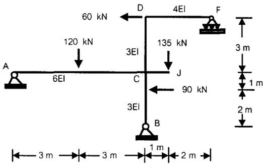
2. (25 คะแนน) จงวิเคราะห์หาค่า end moments ของโครงสร้างในรูปข้างล่างนี้แล้วเขียน bending moment diagram (use moment distribution with successive sway correction)
