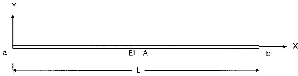
$$\begin{bmatrix} P_{ax} \\ P_{ay} \\ m_a \end{bmatrix} = \begin{bmatrix} EA/L & 0 & 0 \\ 0 & 12EI/L^3 & 6EI/L^2 \\ 0 & 6EI/L^2 & 4EI/L \end{bmatrix} \begin{bmatrix} -EA/L & 0 & 0 \\ 0 & -12EI/L^3 & 6EI/L^2 \\ 0 & -6EI/L^2 & 2EI/L \end{bmatrix} \begin{bmatrix} d_{ax} \\ d_{ay} \\ \theta_a \end{bmatrix}$$
