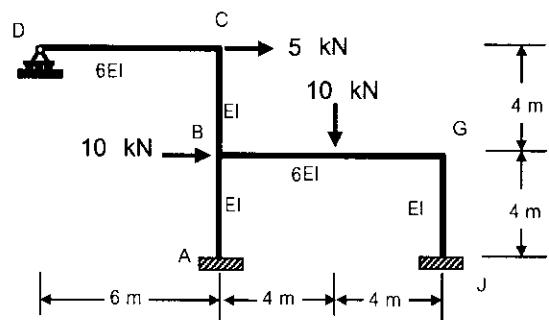
2.(25 คะแนน) โครงสร้างในรูปข้างล่าง รับแรงกระทำ ( working load ) ดังแสดงในรูป ถ้ากำหนดให้ load factor = 2.00 จงหาว่า  $M_p$  จะต้องมีค่าอย่างน้อยเท่าใด และถ้ากำหนดให้  $\sigma_y = 280 \text{ N/mm}^2$  จงออกแบบขนาดหน้าตัดขั้นส่วนต่าง ๆ โดยให้มีหน้าตัดเป็นรูปสี่เหลี่ยมผืนผ้าที่มีความลึกเป็น 2 เท่า ของความกว้าง
