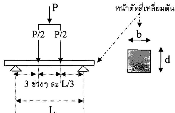
3.1 อธิบาย Modulus of Rupture และจงพิสูจน์หาค่า Modulus of Rupture มีค่าเท่ากับ  $\frac{PL}{bd^2}$
