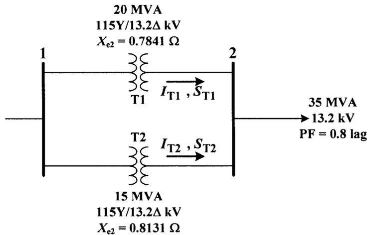
**ข้อ 5** (ก) จงวาดวงจรสมมูล 1 เฟส ของระบบไฟฟ้ากำลังในรูปข้างล่าง ในระบบต่อหน่วย โดยใช้ค่าฐาน 100 MVA 20 kV ในส่วนวงจรของเครื่องกำเนิดไฟฟ้าเป็นค่าฐานของระบบ
