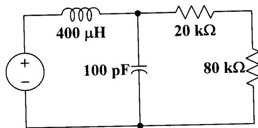
ข้อ 9 จงวิเคราะห์นาฬารามิตเตอร์แบบ [y] ของวงจร 2 พอร์ท ในรูปข้างล่าง
