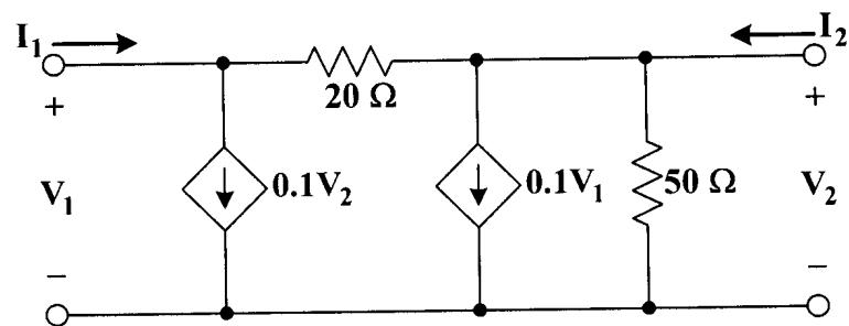
ข้อ 12 จงวิเคราะห์หาพารามิเตอร์แบบ [h] ของวงจร 2 พอร์ท Network c ในรูปข้างล่าง
