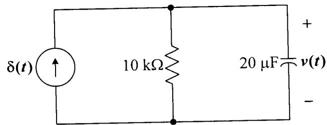
ข้อ 3 จงวิเคราะห์หาผลตอบสนองอิมพลส์ของวงจรในรูปข้างล่าง ถ้าสัญญาณอิมพุทของวงจร คือ  $v_S(t)$  และสัญญาณเอาท์พุทของวงจร คือ  $v_L(t)$
