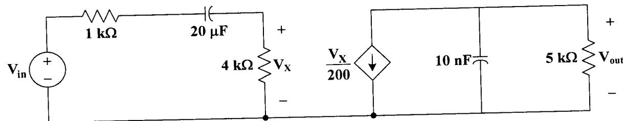
ข้อ 6 จงพล็อตกราฟขนาดแบบ Bode ของวงจรไฟฟ้าที่มีทรานส์เฟอร์ฟังก์ชันดังสมการข้างล่าง
