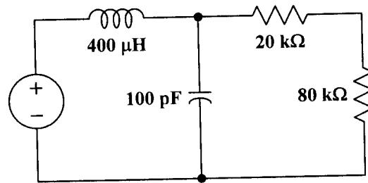
ข้อ 7 จงวิเคราะห์haftparameterr แบบ y ของวงจร 2 พอร์ท ในรูปข้างล่าง
