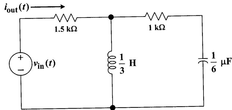
ข้อ 5 จงplot ขนาดของ Frequency response function แบบ Bode ของวงจรไฟฟ้าที่มีทرانส์เฟอร์
