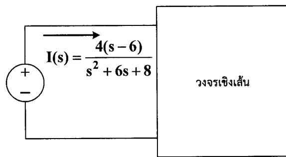
ข้อ 2 จงวิเคราะห์หาผลตอบสนองอิมพล็อกซ์ของวงจรในรูปข้างล่าง ถ้าสัญญาณอินพุทของวงจร คือ  $v_S(t)$
