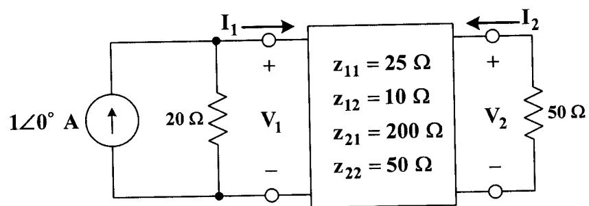
ข้อ 9 จงวิเคราะห์สภาพารามิเตอร์แบบ Z ของวงจร 2 พอร์ท วงจร C ในรูปข้างล่าง
