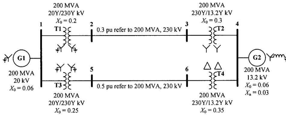
จงวาดวงจรสมมูลลำดับเฟสศูนย์และต้องแทนค่าอิมพีแดนซ์ลำดับเฟสศูนย์ในวงจรด้วยค่าต่อหน่วยที่อ้างอิงกับค่าฐาน 200 MVA 20 kV ในส่วนวงจรของเครื่องกำเนิดไฟฟ้า G1
