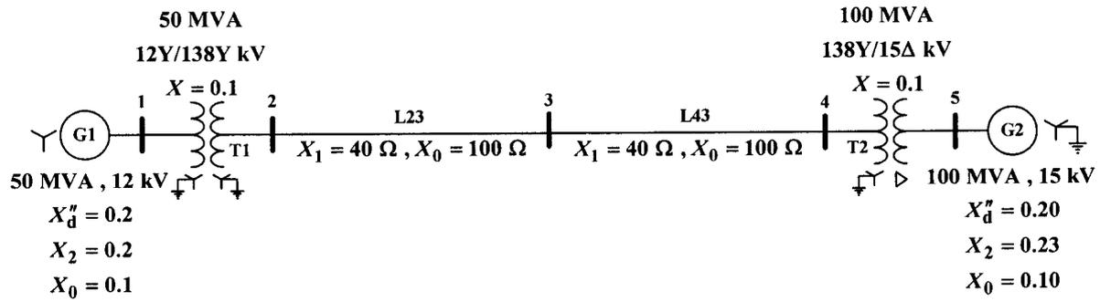
สมมติว่าในสถานะเริ่มต้นระบบทำงานในสภาวะไร้โหลดและแรงดันที่บัส 3 มีขนาด 138 kV ถ้าเกิดลัดวงจรแบบ 2 เฟส ระหว่างเฟส b-c ที่บัส 3 จงวิเคราะห์หากระแสลัดวงจร ณ จุดลัดวงจร ในระบบอ้างอิงเฟส abc กำหนดให้วิเคราะห์ในระบบต่อหน่วย โดยใช้ค่าฐาน 100 MVA 15 kV ในวงจรของเครื่องกำเนิดไฟฟ้า G2 เป็นค่าฐานของระบบ
