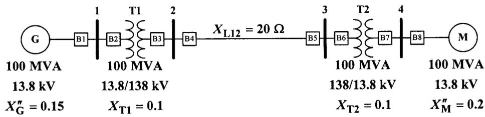
สมมติว่าในสถานะเริ่มต้นระบบทำงานในสภาวะไร้โหลด และแรงดันที่ขั้วของมอเตอร์มีขนาดเท่ากับค่าพิกัดแรงดันของมอเตอร์ ต่อมาเกิดลัดวงจรแบบ 3 เฟส ที่บัส 4 จงวิเคราะห์หากระแสอินเตอร์พท์ที่ไหลผ่านเซอร์กิตเบรกเกอร์ B1 และ B8 ในขณะเกิดลัดวงจรนี้ กำหนดให้วิเคราะห์ในระบบต่อหน่วย โดยใช้ค่าฐาน 100 MVA 13.8 kV ในวงจรของเครื่องกำเนิดไฟฟ้าเป็นค่าฐานของระบบ
