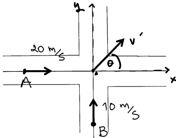
4.4 บล็อก A มวล  $m_A$  และบล็อก B มวล  $m_B$  เลื่อนอยู่บนพื้นในแนวระดับที่ผิวไม่มีความเสียดทาน ด้วยความเร็ว  $v_A$  และ  $v_B$  ตามลำดับดังในรูป ถ้าสัมประสิทธิ์คืนสภาพ ( coefficient of restitution ) เท่ากับ  $e$  จงหาความเร็วของ A ( $v'_A$ ) และ B ( $v'_B$ ) หลังชน
