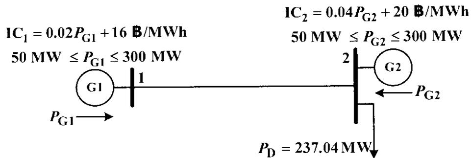
ถ้าส่งกำลังไฟฟ้าจากบัส 1 ไปสู่บัส 2 จำนวน 100 MW จะทำให้เกิดกำลังสูญเสียในสายส่ง 10 MW จงจัดสรรกำลังผลิตตามหลักเศรษฐศาสตร์ให้แก่เครื่องกำเนิดไฟฟ้าทั้งสอง โดยใช้วิธี Bisectional iterative method กำหนดให้ค่าความผิดพลาดที่ยอมรับได้มีค่า 0.01 และ  $\lambda^0 = 20 \text{ B/MWh}$ ,  $\lambda^1 = 30 \text{ B/MWh}$
