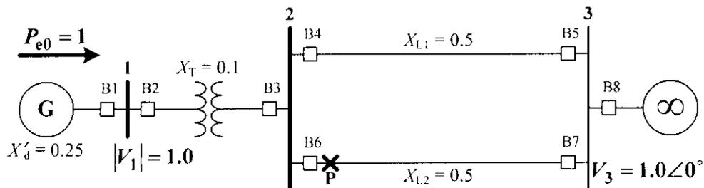
ข้อ 4 ระบบไฟฟ้ากำลัง 50 Hz มีโครงสร้างดังแสดงในรูปข้างล่าง ต่อมาเกิดลัดวงจรแบบ 3 เฟส ณ จุด P หลังจากนั้น ณ เวลา 0.125 วินาที เซอร์กิตเบรกเกอร์ B4,B5 ดำเนินการทริปเพื่อปลดจุดลัดวงจรออกจากระบบ จงวิเคราะห์หาค่ามุมโรเตอร์ของเครื่องกำเนิดไฟฟ้า ณ เวลา 0, 0.05, 0.10, 0.15, 0.20 วินาที โดยใช้วิธี Step-by-step กำหนดค่า  $\Delta t = 0.05$  วินาที
