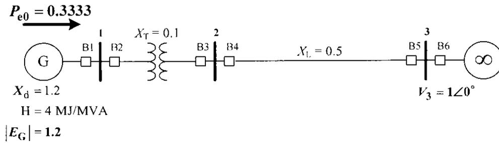
**ข้อ 3** ระบบไฟฟ้ากำลัง 50 Hz ซึ่งมีโครงสร้างดังแสดงในรูปข้างล่าง กำลังทำงานในสถานะอยู่ตัว ต่อมาเกิดลัดวงจรแบบ 3 เฟส ณ จุด P ซึ่งอยู่ใกล้กับบัส 2 มาก จงวิเคราะห์หาค่ามุมวิกฤต  $\delta_{cr}$  ของเซอร์กิตเบรกเกอร์ B6 และ B7
