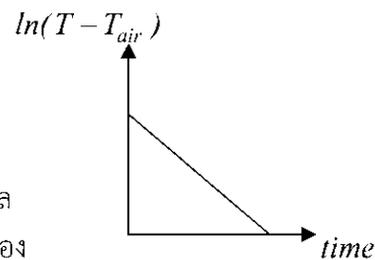
5. จากกราฟข้อที่ 3 ถ้าความชันกราฟมีค่าเท่ากับ  $-1/100$  และแท่งทองแดงมีอุณหภูมิเริ่มต้นเท่ากับ  $50^{\circ}\text{C}$  อากาศมีอุณหภูมิ  $30^{\circ}\text{C}$  จงหาว่าจะใช้เวลาประมาณเท่าไรเพื่อให้แท่งทองแดงมีอุณหภูมิใกล้เคียงกับอากาศ (กำหนดให้  $\ln(20) \approx 3$ )
