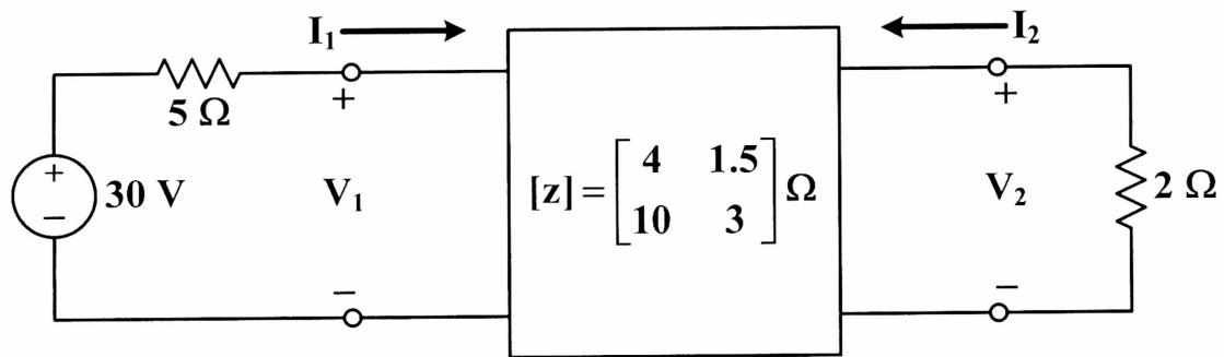
ข้อ 9 จงวิเคราะห์หาพารามิเตอร์แบบ  $t$  ของวงจร 2 พอร์ท ในรูปข้างล่าง
