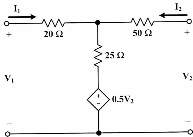
ข้อ 8 จงวิเคราะห์หาค่าอัตราส่วน  $V_2/V_1$
