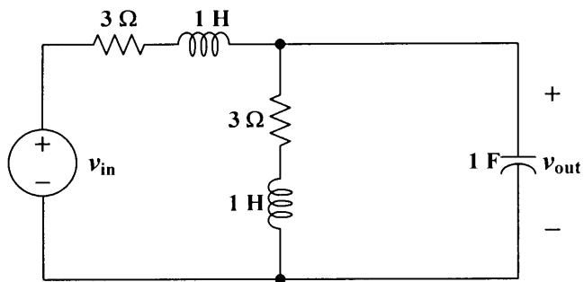
ข้อ 4 จงวิเคราะห์หาค่า Gain และ Phase shift ของวงจรไฟฟ้าในรูปข้างล่าง ซึ่งทำงาน ณ ความถี่ 2 rad/s
