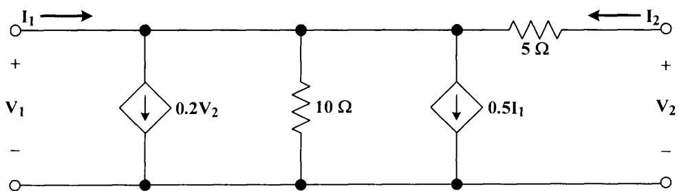
ข้อ 8 จงวิเคราะห์หาค่าอัตราส่วน  $V_2 / V_1$  ของวงจรไฟฟ้าในรูปข้างล่าง
