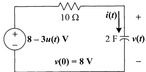
ข้อ 2 (ก) จงแปลงวงจรไฟฟ้าในรูปข้างล่างไปเป็นค่าความถี่เชิงซ้อน  $s$  โดยกำหนดให้แหล่งจ่ายที่เกิดจากเงื่อนไขในขณะเริ่มต้นวงจร ต้องแสดงในรูปแหล่งจ่ายกระแสเท่านั้น
