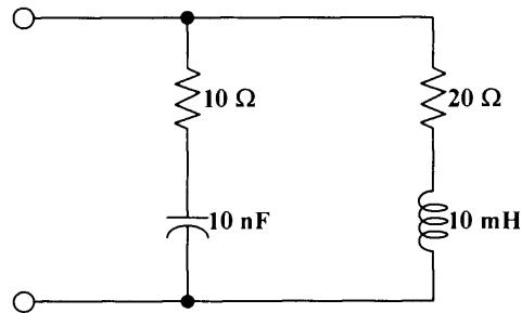
ข้อ 7 จงวิเคราะห์หา parameter แบบ  $y$  และแบบ  $z$  ของวงจรไฟฟ้าในรูปข้างล่าง
