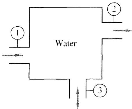
4.2 จากรูป จงหาเวลาที่ใช้สำหรับถ่ายน้ำที่เต็มถังออกจากถังให้หมด เมื่อน้ำไหลออกจากรูเต็มถังด้วยความเร็ว  $(2gh)^{1/2}$  โดยที่  $h$  คือความสูงของน้ำเหนือรู กำหนดให้พื้นที่ก้นถังและพื้นที่รู คือ  $A_b$  และ  $A_o$  ตามลำดับ
