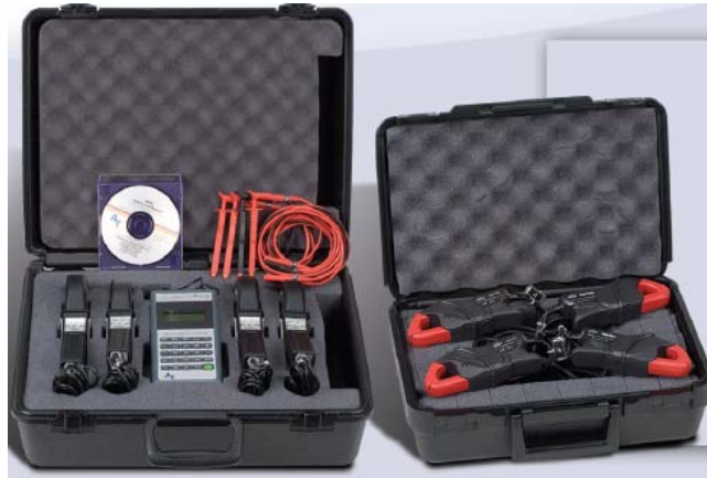
รูปที่ 2 ตัวอย่างเครื่องมือวัดสภาพมอเตอร์ที่นำเข้ามาจากต่างประเทศ
