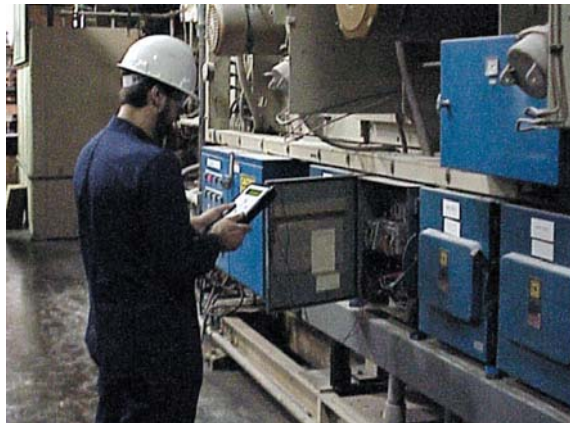
รูปที่ 3 แสดงการใช้เครื่องมือวัดตรวจสอบสภาพทางไฟฟ้ามอเตอร์ในโรงงาน
