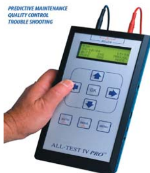
รูปที่ 1 ตัวอย่างเครื่องมือแบบพกพาในการวินิจฉัยปัญหาของมอเตอร์ไฟฟ้า ผิดพลาด! ไม่พบแหล่งการอ้างอิง
