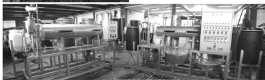
เครื่องผลิตไฮโดรเจนเปอร์ออกไซด์จากน้ำมันปาล์มดิบชนิดหีบรวม แบบต่อเนื่องขนาด 50 ลิตรต่อชั่วโมง (งานวิจัยระดับปริญญาเอกของ นายสุรัชย์ จันทร์ศรี ยื่นขอจดอนุสิทธิบัตรเลขที่คำขอ 1103000539 เรื่อง ระบบผลิตไฮโดรเจนเปอร์ออกไซด์แบบสองขั้นตอน)
