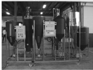
เครื่องผลิตไฮโดรเจนเปอร์ออกไซด์จากน้ำมันปาล์มดิบ หรือน้ำมันที่ผ่านการใช้แล้ว ขนาด 100 ลิตรต่อครั้ง (จัดสร้างถวายสมเด็จพระเทพรัตนราชสุดาฯ สยามบรมราชกุมารี ครึ่งเสด็จพระราชดำเนินมายัง มหาวิทยาลัยสงขลานครินทร์ เมื่อวันที่ 5 มกราคม 2552 เพื่อพระราชทานให้แก่กลุ่มชาวประมง จ.พังงา ซึ่งเป็นเครื่องต้นแบบในการผลิตไฮโดรเจนเปอร์ออกไซด์ แก่ชุมชนขนาดเล็ก ภายใต้การดูแลของมูลนิธิชัย)
